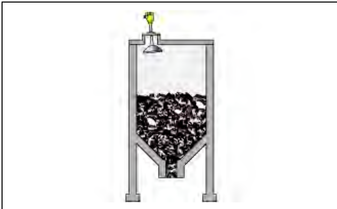
Abb. 7: Füllstandmessung in einem Klinkersilo mit VEGAPULS 68
