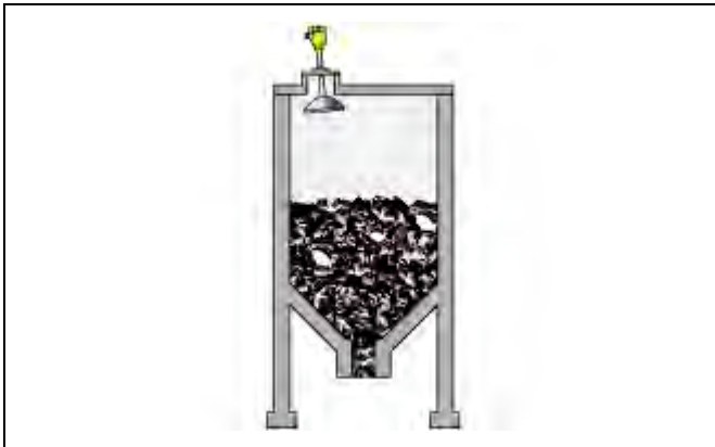
Fig. 7: Mesure de niveau dans un silo de klinker avec le VEGAPULS 68
